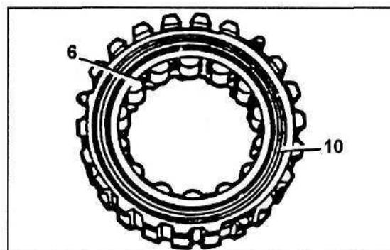
5. Проверьте беговые поверхности наружного кольца муфты свободного хода (10) на предмет задиrow и повреждений.
