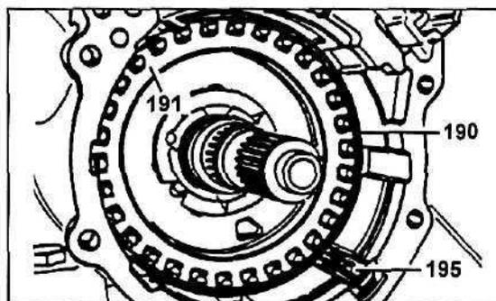
6. Измерьте с помощью микрометра зазор "S" и при необходимости отрегулируйте его.
