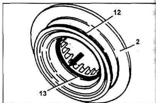
Установите оправку (021) на внешний барабан (1). Нанесите на оправку и кольцевые уплотнения (12,13) трансмиссионное масло, а затем аккуратно установите поршень (2) в барабан.
