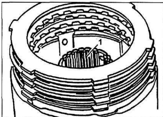
3. Установите приспособление (020) на упор пружин, сожмите и удалите стопорное кольцо (5).
