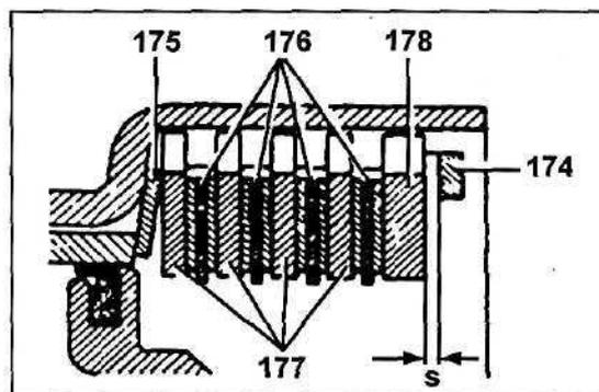
9. Измерьте с помощью микрометра свободный ход поршня муфты KS "S" и отрегулируйте его с помощью стопорного кольца (174) до величины 1,5 - 2,1 мм.
