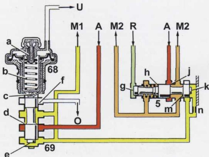
Рис. 5. 5 - Клапан регулирования давления M2; 68 - Модулятор; 69 - Клапан регулирования давления модулятора M1; А - Рабочее давление; M1 - Давление модулятора; M2 - Давление, определяемое давлением модулятора M1 и давлением скоростного регулятора; O - Слив в поддон; R - Давление скоростного регулятора; U - Разряжение во впускном коллекторе; a - Регулировочный винт; b - Пружина; c - Пластмассовый толкатель; d, e, f, g, h, j, k, m - Кольцевые канавки; n - Жиклер.
