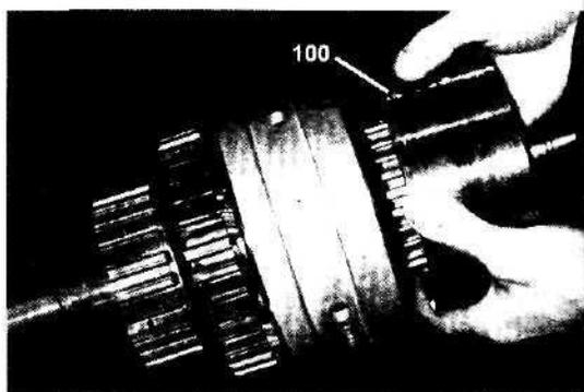
16. Вращая планетарный механизм за входной вал (87) установите его в картер коробки передач.
