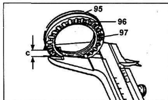
30. Установите с использованием смазки тефлоновые кольца (9). Проверьте, чтобы разрез полностью сомкнулся (стрелка). При необходимости вытащите кольца и уменьшите их длину.
