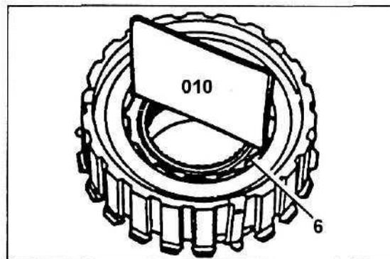
4. Удалите сепаратор роликов (6) из наружного кольца муфты свободного хода (10).
