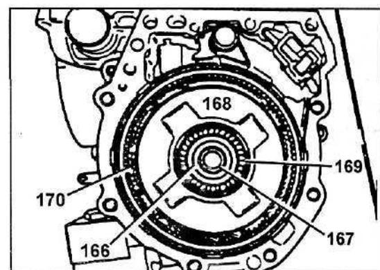
Измерьте зазор между выходным и промежуточным валом.
