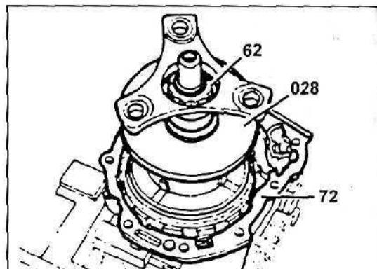
18. Измерьте с помощью штангенциркуля расстояние между пластиной (028) и прокладкой (72).
