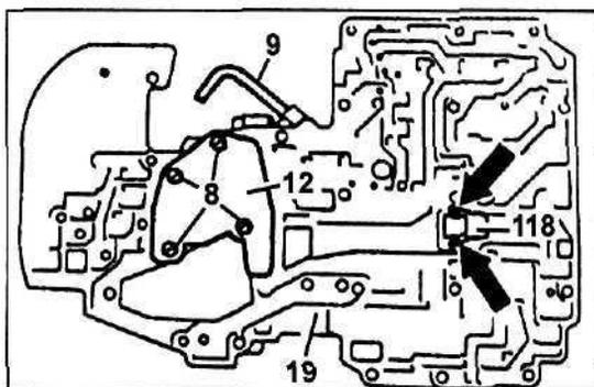
10. Открутите крепежный винт (стрелка) и удалите клапан соленоида понижения передачи (Y3/1y1).
