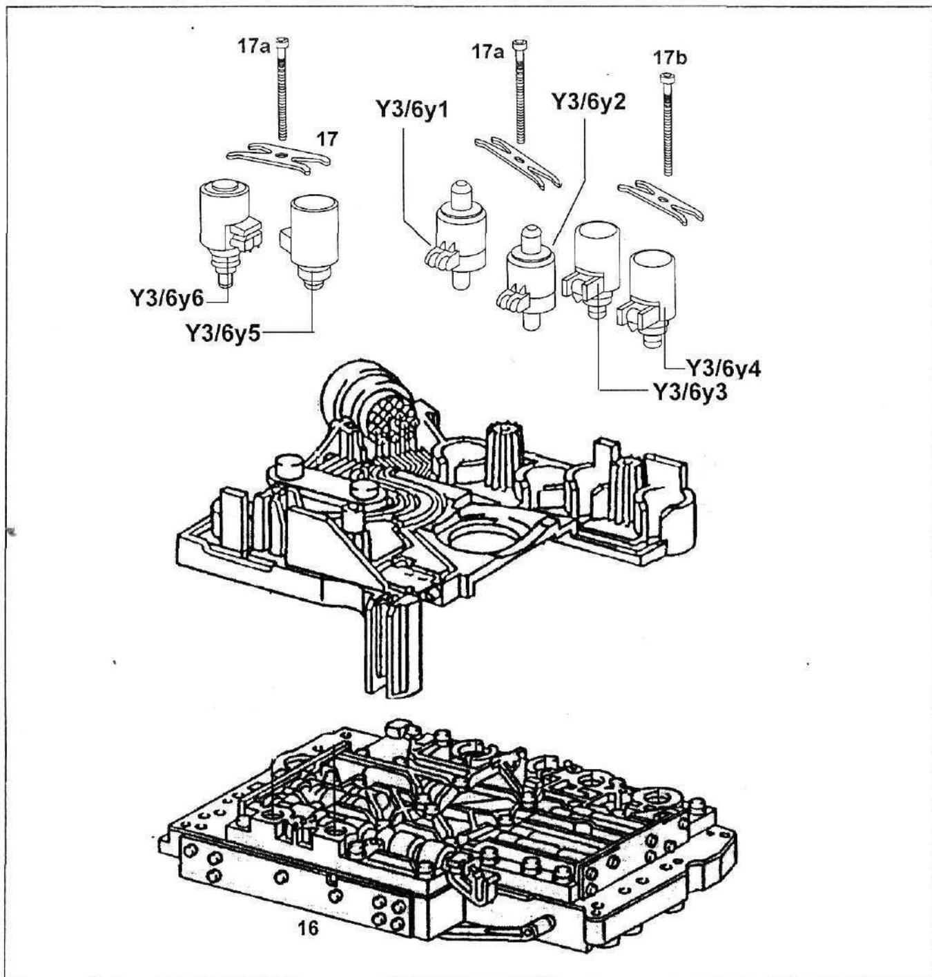
Рис. 105. Разборка и сборка электрогидравлического блока управления.
