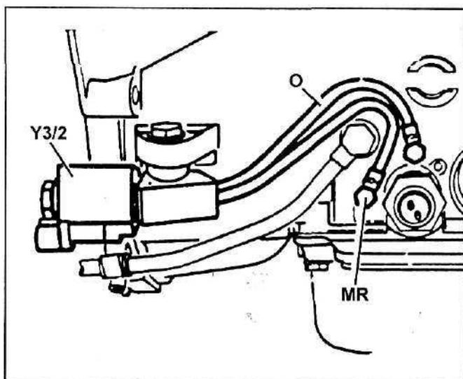
Задержка переключения 2-3 эффективна только при температуре охлаждающей жидкости 0-60°C. Продолжительность действия соленоида зависит от температуры охлаждающей жидкости в момент запуска двигателя. Наибольшая продолжительность бывает при температуре 20-30°C и составляет 60-80 секунд.
