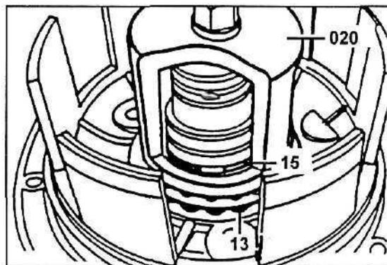
5. Извлеките упор пружин (13) и возвратные пружины (14) поршня тормоза ВЗ (12).
