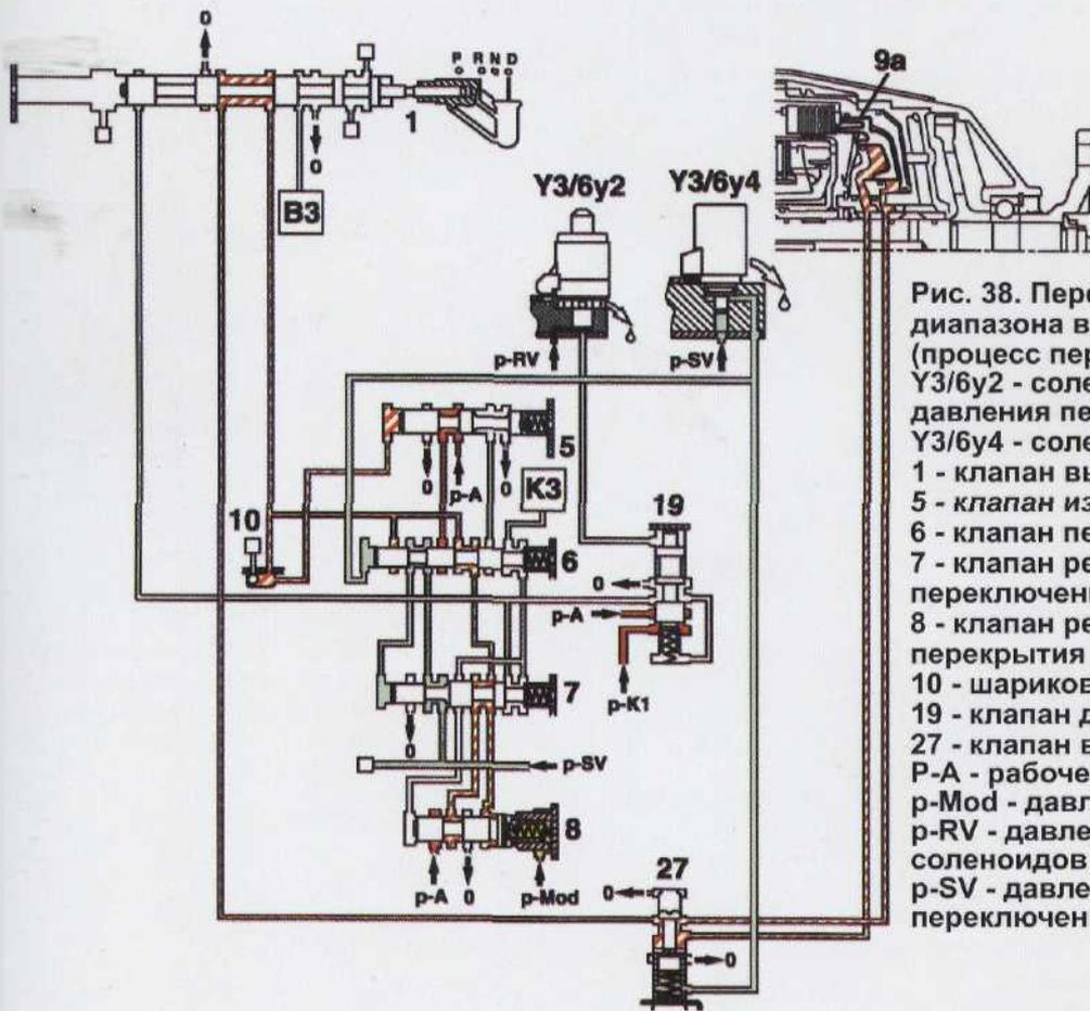
Рис. 38. Перевод рычага выбора диапазона в положение "D" (процесс переключения).
