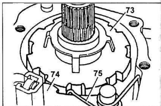
50. Измерьте осевой люфт (С) ведомого вала (муфта К2) и отрегулируйте его.
