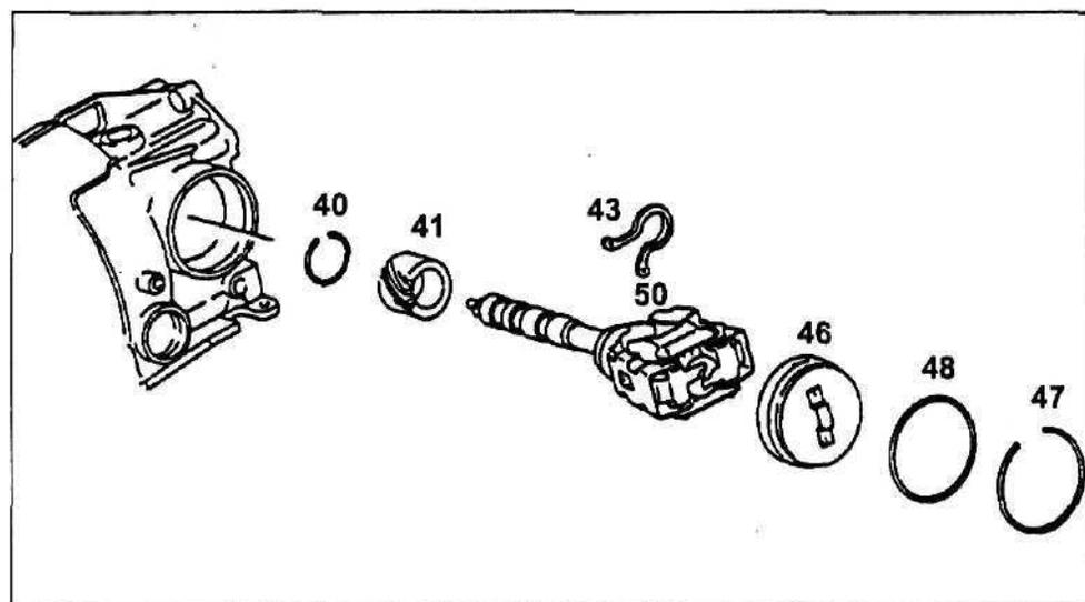
Рис. 58. Скоростной регулятор.
