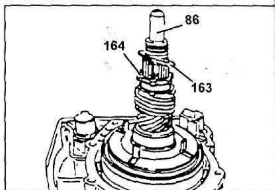
Измерьте зазор между выходным валом и задним фланцем картера.
