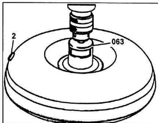
38. Прикрутите к масляному радиатору шприц (064), заполненный смесью воды с керосином и промойте масляный радиатор и маслопроводы (12) и (13).
