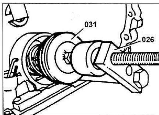
62. Установите стопорное кольцо (41). Верните на место гайку приспособления (026) и снимите его.
