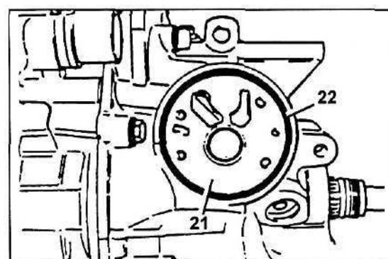
25. Установите вспомогательный насос (20), закрутите винты (45) М6х30 и затяните их.
