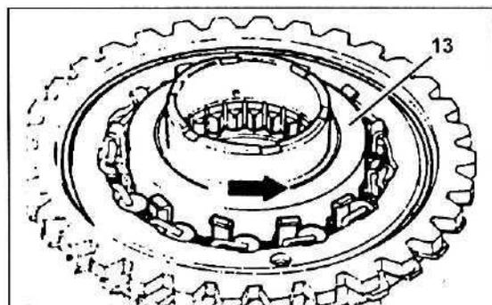
10. Вдавите цилиндрические ролики (16) в пружины (15) и вставьте удерживающие пластины (085) (16 штук).
