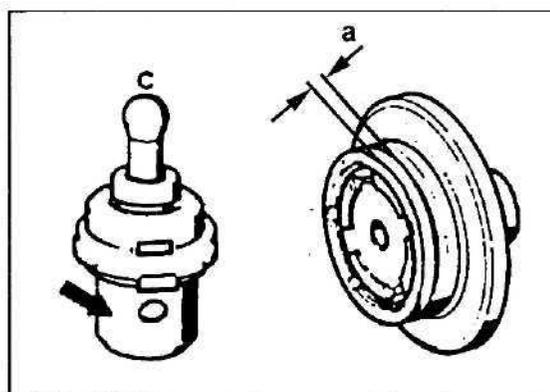
10. Установите упорную шайбу (113) так, чтобы язычок замка от прокручивания (стрелка) попал в канавку картера.
