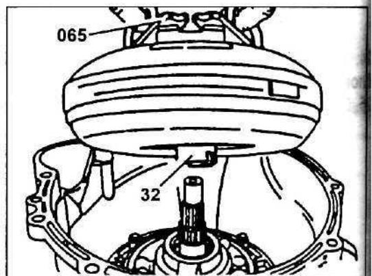
37. Наполните трансформатор водой, разбавленной 1 литром керосина. Установите промывочную оправку (063) и медленно вращайте трансформатор в течении 2-х минут. Затем открутите сливную пробку и слейте промывочную жидкость. Повторите эту процедуру 3-4 раза. После последней промывочная жидкость должна быть чистой.
