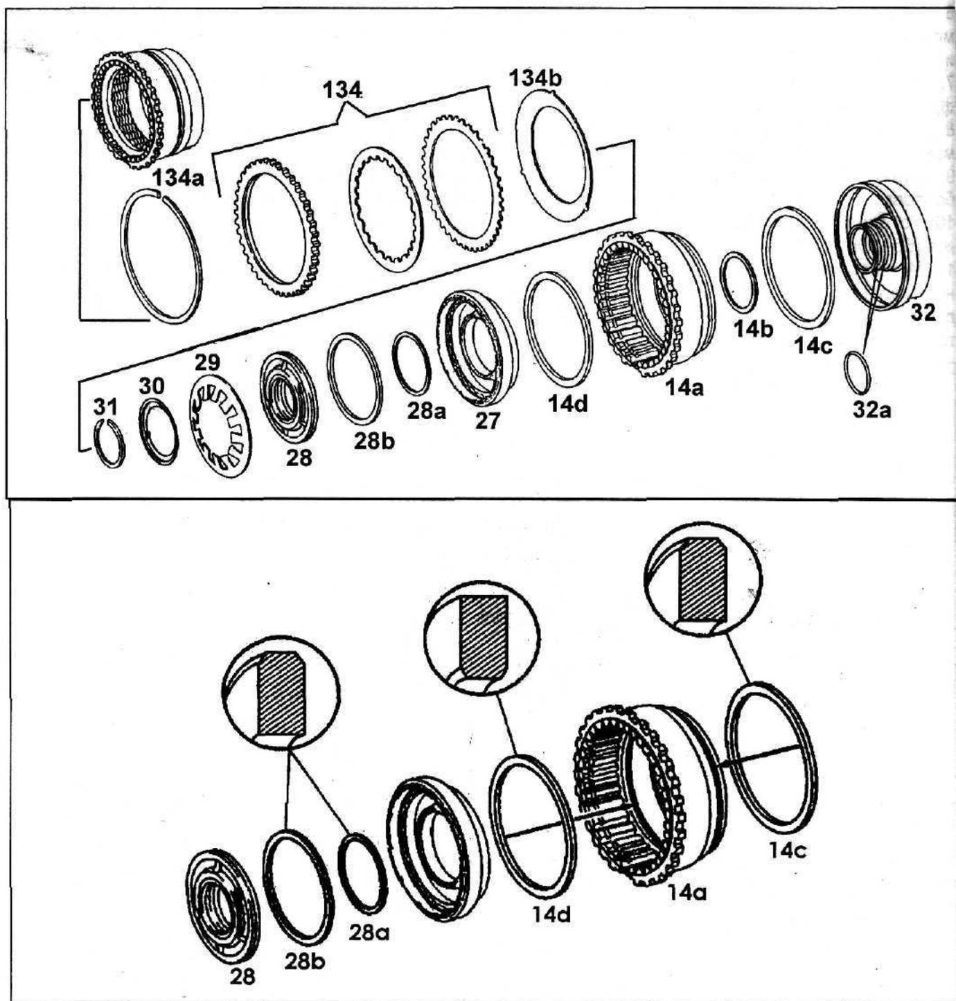
Рис. 63. Разборка и сборка дискового тормоза В2.
