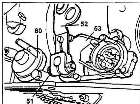
18. Открутите болт с шестигранной головкой (55) и снимите выключатель блокировки стартера (53).
