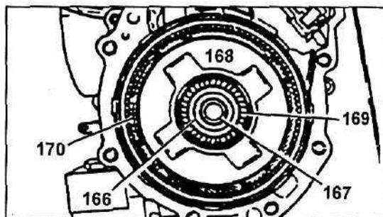
3. Извлеките солнечную шестерню (171) и эпициклическое колесо (170).
