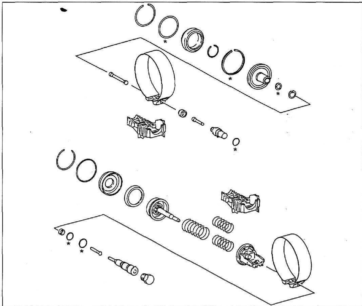
Рис. 61. Последовательность сборки сервопривода и ленточного тормоза.
