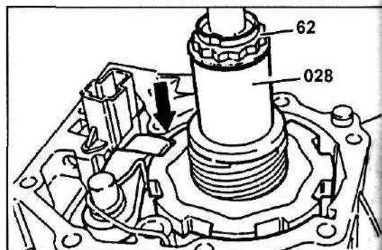
Установите уплотнение (72). Положите брусок с параллельными сторонами (029). Измерьте с помощью штангенциркуля расстояние от измерительной втулки (028) до бруска. Добавьте к этому расстоянию 15 мм и получите размер "b".
