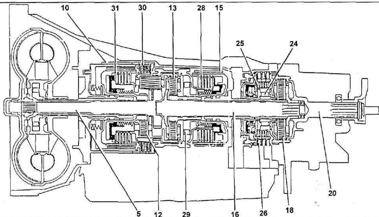
Рис. 66. Автоматическая коробка передач 722.5. 5 - Ведущий вал, 10 - Ленточный тормоз В1, 12 - Планетарный ряд со сцепленными сателлитами, 13 - Средний планетарный ряд, 15 - Ленточный тормоз В2, 16 - Промежуточный вал, 18 - Повышающий планетарный ряд, 20 - Ведомый вал, 24 - Муфта свободного хода F2, 25 - Блокировочная муфта KS, 26 - Дисковый тормоз BS, 28 - Блокировочная муфта K2, 29 - Муфта свободного хода F1, 30 - Дисковый тормоз В3, 31 - Блокировочная муфта K1.
