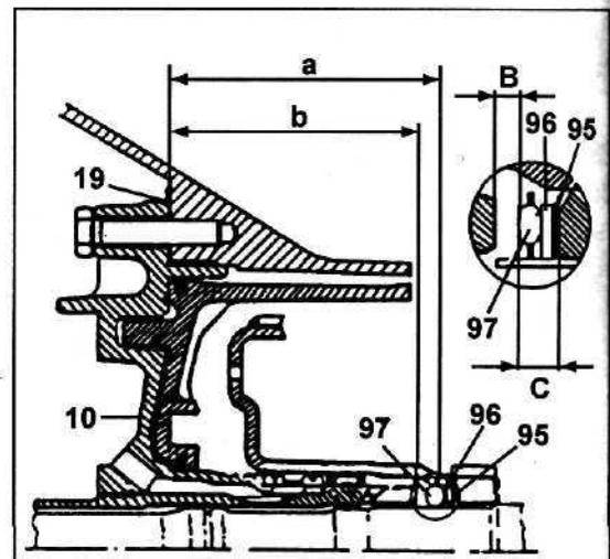
Установите на валу брусок (стрелка) с параллельными сторонами (029).
