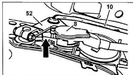
4. Открутите болт (51) и снимите рычаг выбора диапазона (52).
