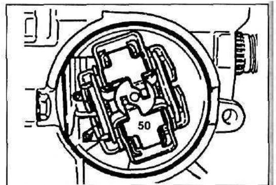
23. Установите плоскогубцами стопорное кольцо (47) в положение, показанное на рисунке; удалите стопорное кольцо, а затем выдвиньте регулятор (50) из картера так, как только возможно.
