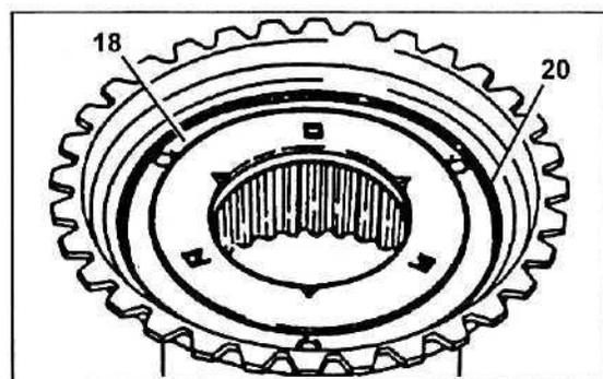
20. Проверьте зазор в муфте свободного хода и отрегулируйте его. Проверьте с помощью щупа зазор между муфтой свободного хода и наружным барабаном (7).
