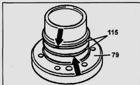
6. Вставьте фланец (79) в отверстие, используя для центровки два болта, длиной 80 мм.
