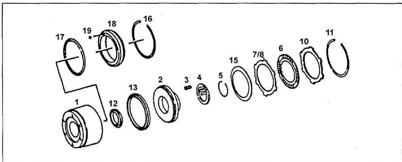
Рис. 64. Порядок разборки и сборки муфты К1.
