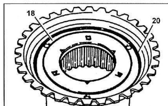
14. Проверьте зазор в муфте свободного хода и отрегулируйте его. Проверьте с помощью щупа зазор между муфтой свободного хода и наружным барабаном (7).
