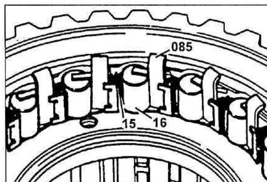
11. Снимите цилиндрические ролики (16) и сепаратор (14) вместе с пружинами (15). Проверьте их исправность.
