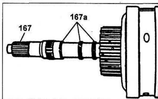
3. Установите приспособление так, чтобы две установочные поверхности были направлены вверх. Вставьте планетарный механизм промежуточным валом вперед в монтажное приспособление.
