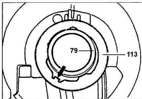
12. Установите упорную шайбу (113) так, чтобы язычок предотвращал ее вращение относительно картера (стрелка).
