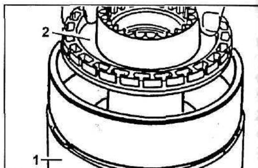
8. Проверьте кольцевое уплотнение (17) между внешним барабаном (1) и направляющим кольцом поршня (18) на утечки, заполняя для этого направляющее кольцо поршня небольшим количеством керосина. При появлении утечек в кольцевом уплотнении удалите стопорное кольцо (16), извлеките поршень и замените уплотнение.
