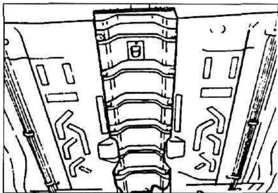
18. Ослабьте гайки крепления подвесного подшипника (7).
