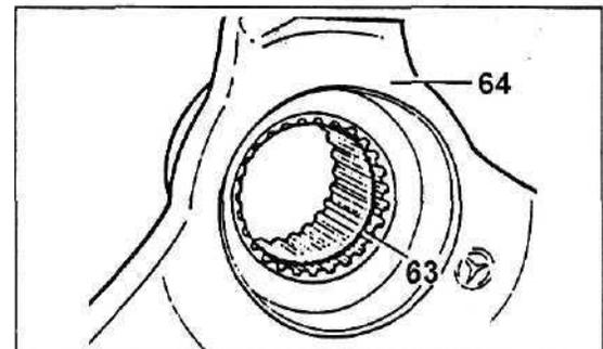
54. Установите задний фланец (64) и закрепите его шестигранной гайкой (62).
