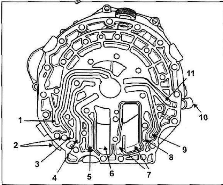
Рис. 119. Назначение отверстий в картере гидротрансформатора.
