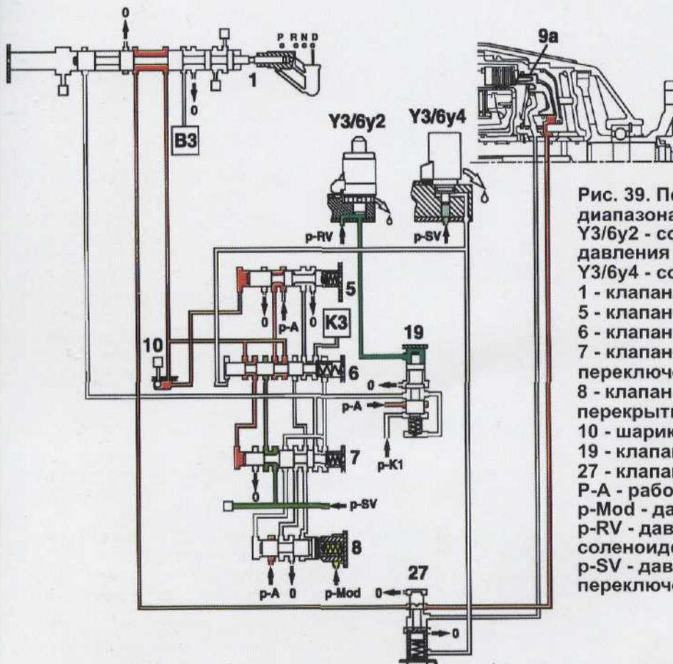
Рис. 39. Положение рычага выбора диапазона "D" (первая передача).
