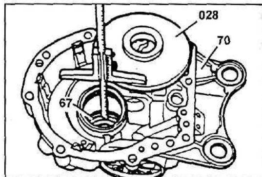
*Измерение размера "b":*
