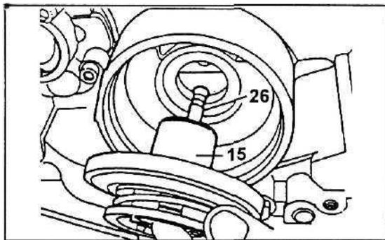
12. Для удаления поршня тормоза В1 установите приспособление (026) и вкрутите его в картер коробки передач.
