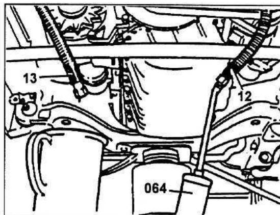
39. Добавьте через заливную горловину трансмиссионного масла. Уровень масла при рабочей температуре коробки передач (80°C) должен быть максимальным (стрелка).
