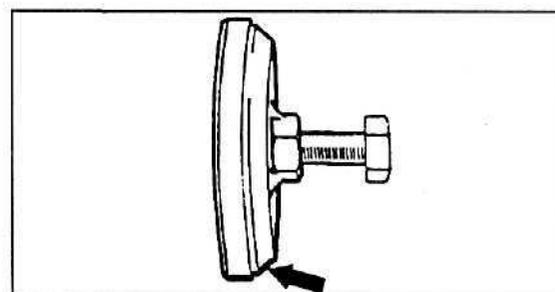
63. Измерьте и отрегулируйте зазор "L" в выключенном состоянии ленточного тормоза В1.
