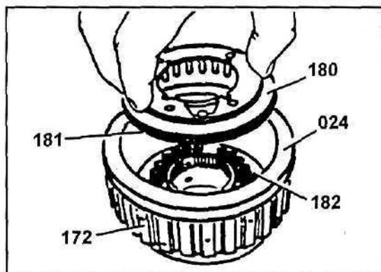
6. Установите стопорное кольцо (179). Установите приспособление (020) и сожмите. Установите стопорное кольцо и проверьте правильность его установки.
