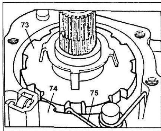
28. Для транспортных средств с механическим спидометром надо снять маслопровод (102), механизм блокировки выходного вала коробки передач (73), щеколду (74) и пружину (75).
