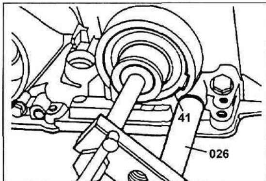
14. Используя приспособление (026), извлеките поршень тормоза В1 (37) вместе со штоком и возвратными пружинами (35,36).
