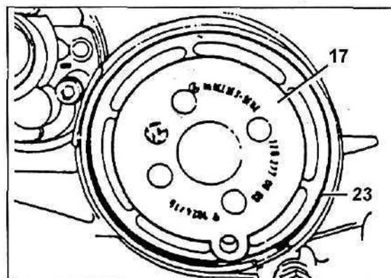
70. Измерьте люфт "L" свободного хода ленточного тормоза В2 и отрегулируйте его.
