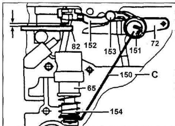
В дополнение к уже имеющимся функциям - запрета переключения рычага выбора диапазона в позиции "N" и "R" - механизм блокировки (65) получил теперь две дополнительные функции. Теперь поршень механизма блокировки имеет три фиксированных положения вместо одного. Два стопорных рычага (152), соединенных со штоком поршня механизма блокировки тягой (150), поворачивают защелку (82), которая предотвращает перемещение рычага выбора диапазона в понижающую позицию.
