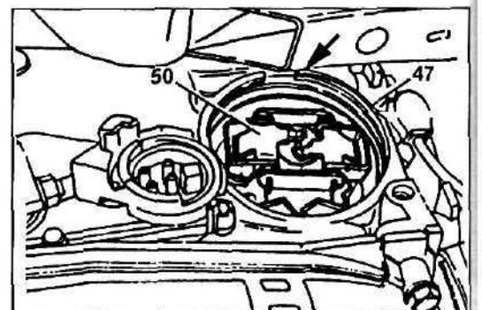
24. Плоскогубцами (072) нажмите с правой стороны на фиксатор и окончательно удалите регулятор.
