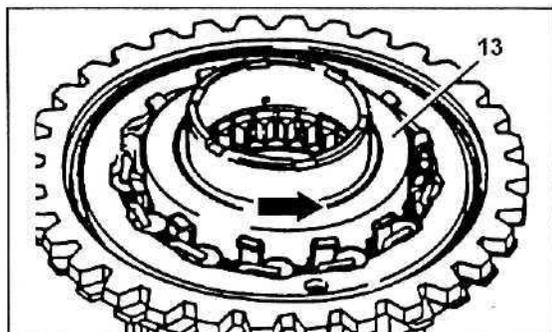
16. Вдавите цилиндрические ролики (16) в пружины (15) и вставьте удерживающие пластины (085) (16 штук).
