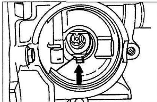
25. Удалите стопорное кольцо (40) и снимите шестерню (41).
