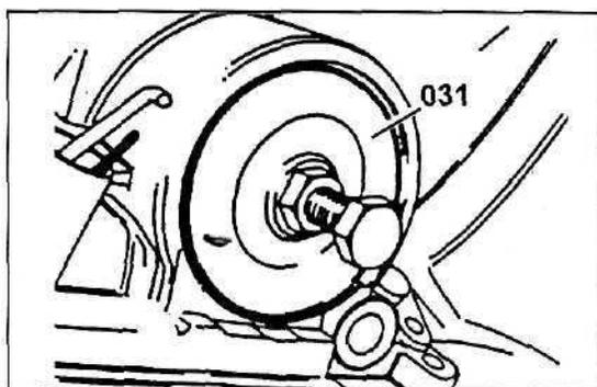
Закрутите до упора вручную болт на приспособлении (031). Далее закручивайте болт динамометрическим ключом до момента 1 Н·м, считая при этом число оборотов. Свободный ход ленты должен быть 1,8 - 2,5 мм, т.е. крутящий момент 1 Н·м должен быть достигнут при 1,8 - 2,5 оборота динамометрического ключа.
