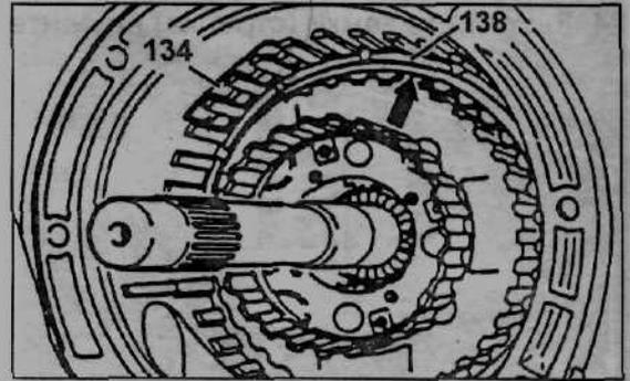
20. Последовательность установки металлических дисков и дисков с фрикционными накладками тормоза ВЗ показана на рисунке.
