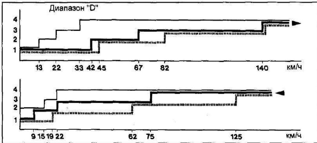
Рис. 2. Примерные диаграммы переключений передач на диапазоне "D".
