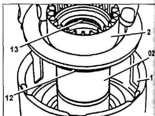
6. Измерьте с помощью щупа зазор "А".
