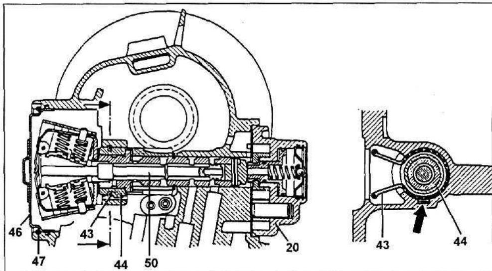
Рис. 60. Скоростной регулятор 722.4.
