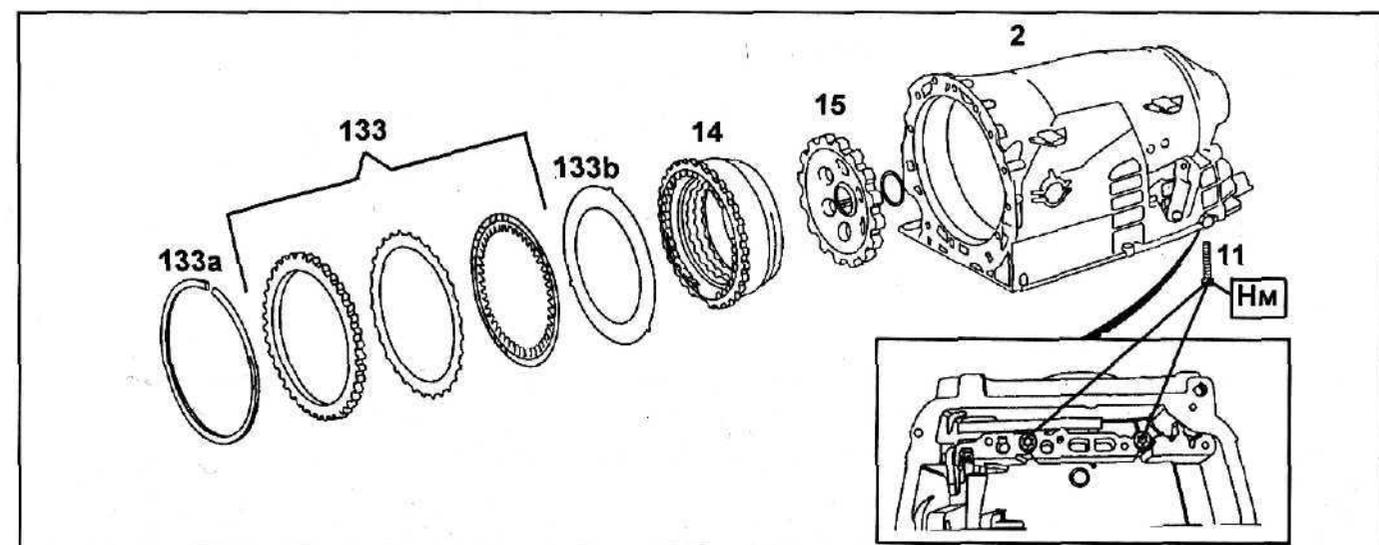
**Рис. 67. Разборка и сборка дискового тормоза В3.**
