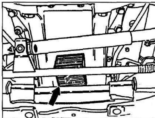
13. Отсоедините систему выпуска отработавших газов (стрелки) и частично приподнимите двигатель (это относится к двигателям 116,117). Двигатель 119 вытаскивают полностью. Для двигателей 103 и 104 следует отсоединить систему выпуска на задней подвеске, аккуратно приспустите двигатель и подвесе.
