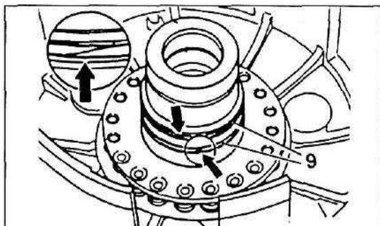
4. Установите приспособление (020) на упор пружин (13). Удалите упорное кольцо (15). Снимите приспособление.
