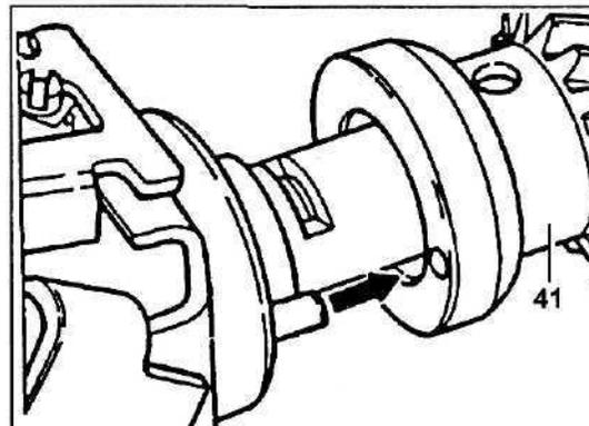
26. Снимите центробежные грузики (f) и проверьте плунжер регулятора, что просто сделать через отверстия, показанные стрелками.
