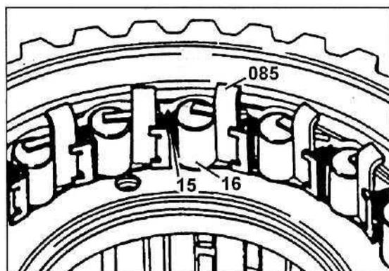
17. Снимите цилиндрические ролики (16) и сепаратор (14) вместе с пружинами (15). Проверьте их исправность.
