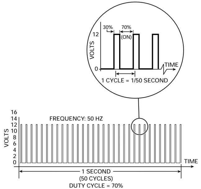
FIGURE A: 3-2 DOWNSHIFT CONTROL SOLENOID NEGATIVE DUTY CYCLE
