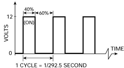
FIGURE B: PRESSURE CONTROL SOLENOID POSITIVE DUTY CYCLE
