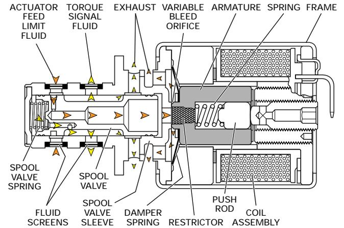
FIGURE A: PRESSURE CONTROL SOLENOID
